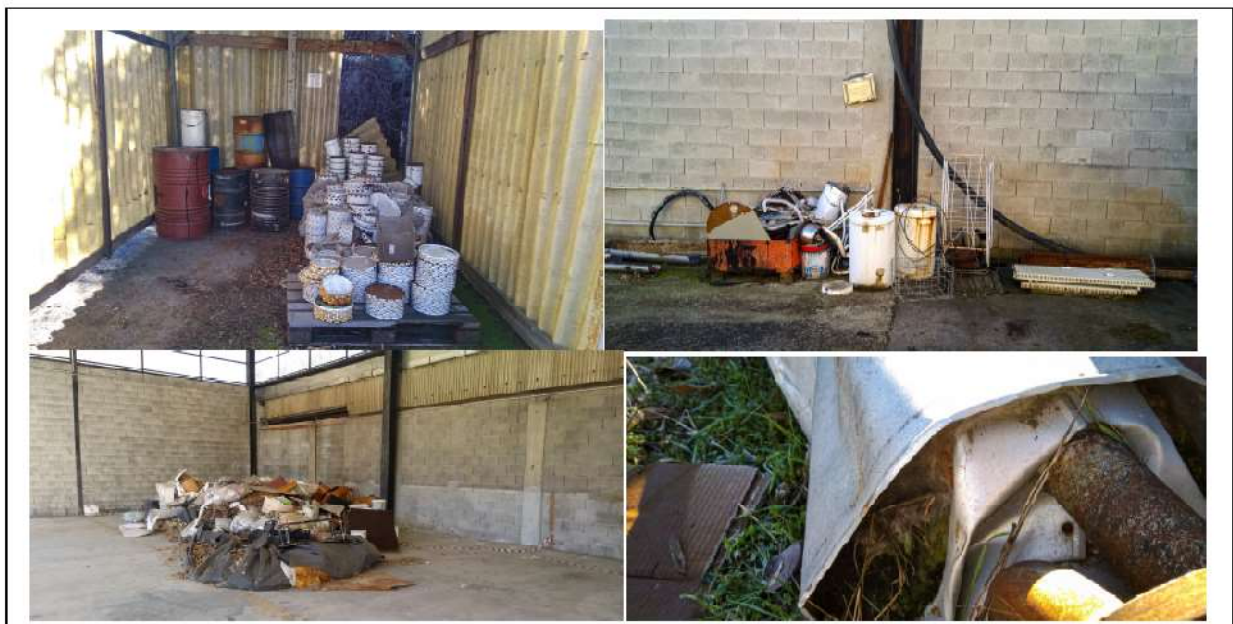
Fotografia 9: serbatoio dismesso in stato di abbandono depositato a lato del magazzino 12 E contenente all'interno si presume bitume solido e esternamente si vede parte della coibentazione presumibilmente in lana ceramica o lana di roccia, a fianco è depositato un rottame ferroso contaminato da bitume.
