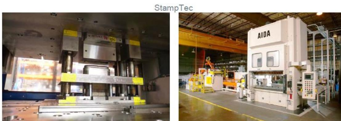
StampTec è il sistema magnetico di bloccaggio rapido stampi che rispetto ad un tradizionale fissaggio meccanico, velocizza nettamente la procedura: è sufficiente posizionare lo stampo in macchina, chiuderla, magnetizzare il modulo superiore e quello inferiore, aprire la macchina. In pochi secondi lo stampo è pronto per la produzione, bloccato saldamente e perfettamente allineato, senza alcun ulteriore intervento dell'operatore.
