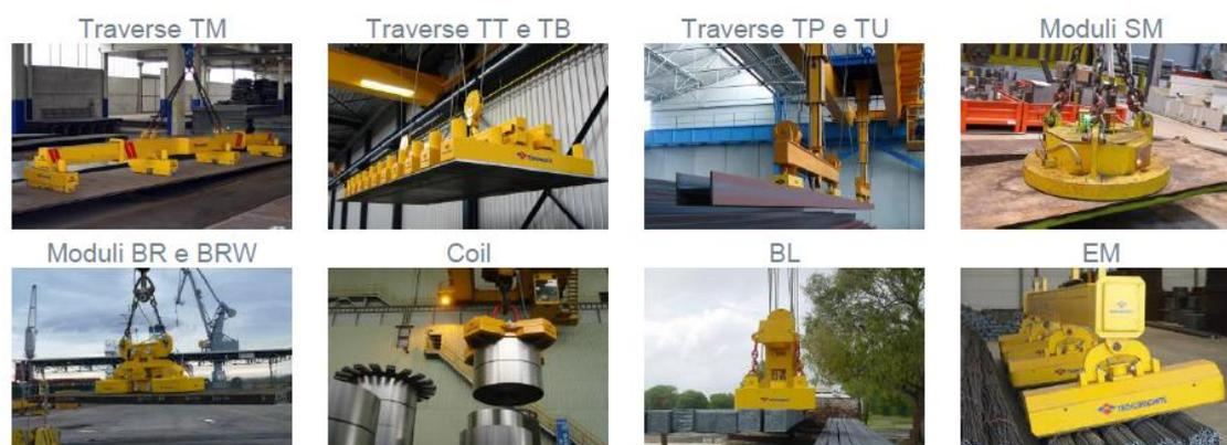
I sollevatori elettropermanenti facenti parte della serie denominata Tecnolift agganciano, trasportano e sganciano il carico con estrema facilità, operando sempre al di sopra del carico, senza comprimerlo né deformato.
