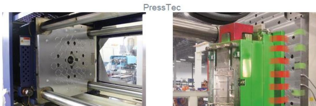
Si tratta della tecnologia introdotta da TECNOMAGNETE nel 1996 per il bloccaggio rapido degli stampi che ha portato ad avere una serie di vantaggi rispetto ai sistemi meccanici ed idraulici:
