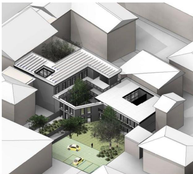
L'intervento proposto consiste nella realizzazione di un nuovo edificio che si sviluppa su quattro livelli e ospita al piano interrato otto box auto, otto cantine, un locale tecnico, il vano scala con disimpegno e la rampa di accesso (che rimane della stessa forma di quella attuale).
