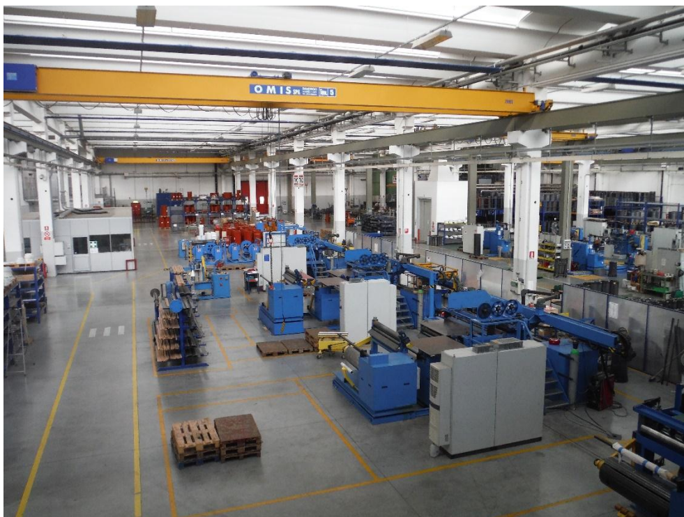
Fotografia 49. Avvolgatrici bassa tensione.
