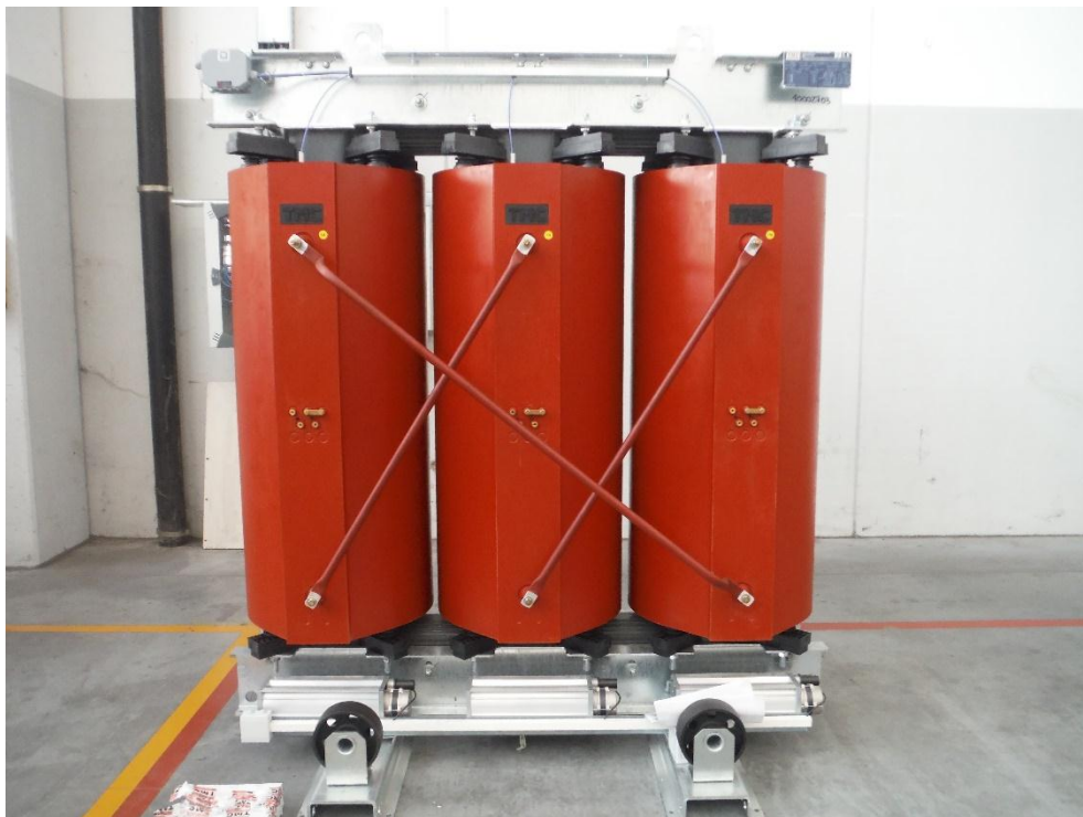
Fotografia 60. Trasformatore ultimato presso l'area prodotti finiti.
