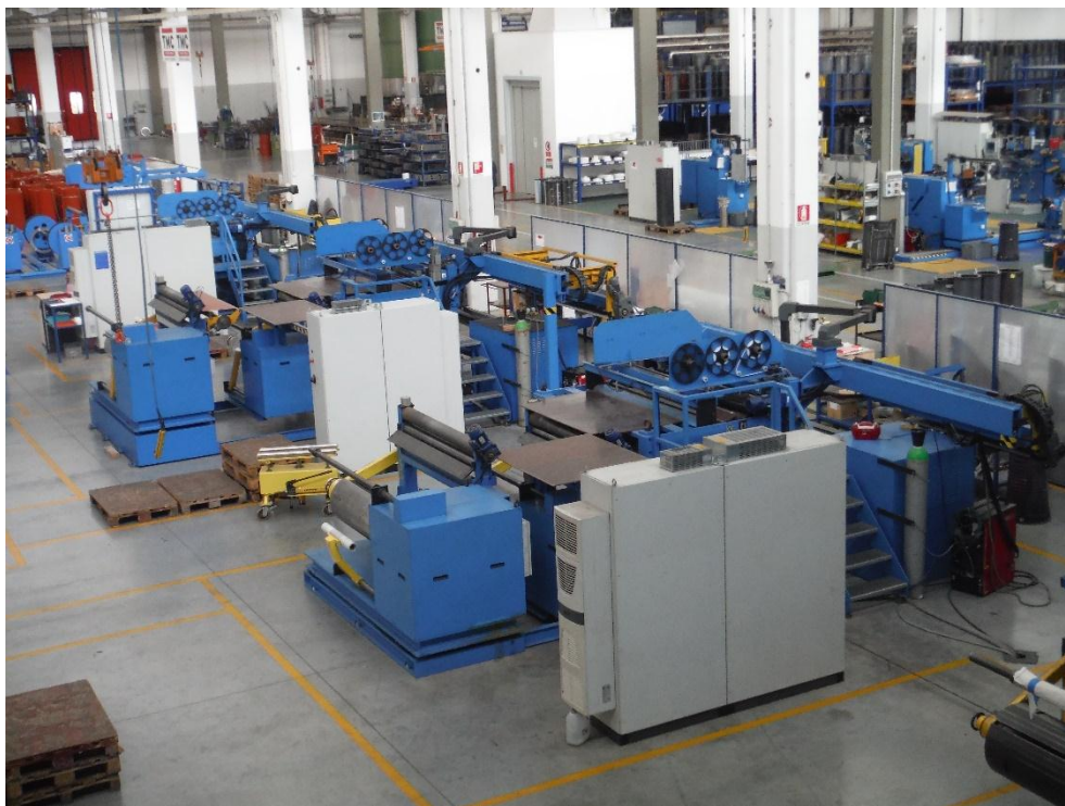
Fotografia 51. Avvolgitrici bassa tensione.
