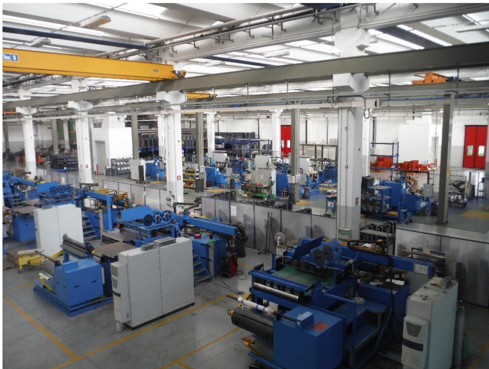
Fotografia 50. Avvolgitrici bassa e media tensione.
